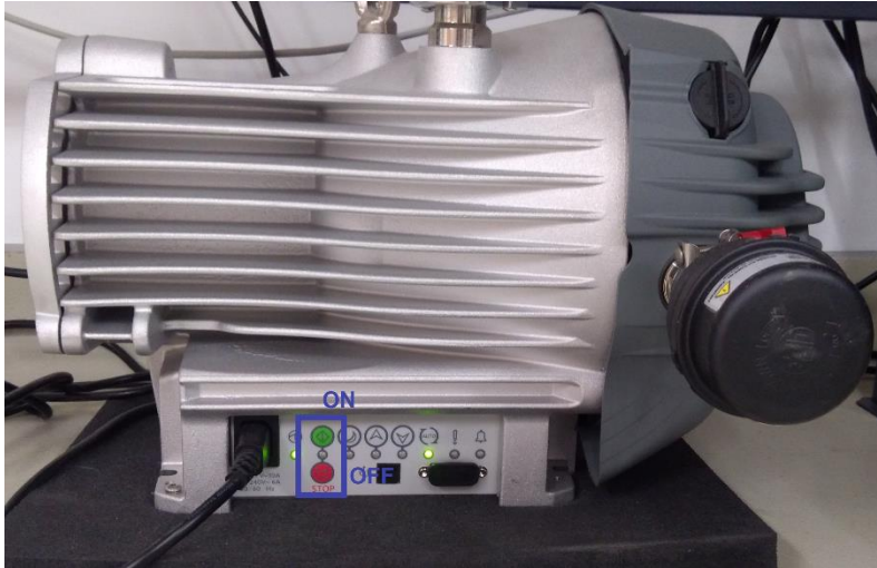
Rys. 2. Pompa próżniowa i zawór powietrza (na zdjęciu w pozycji zamkniętej)
