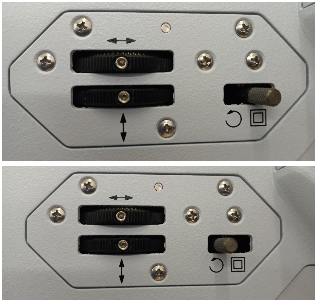
Rys. 17. Apertury mechaniczne. Góra – tryb zsuwania i rozsuwania. Dół – tryb obracania
