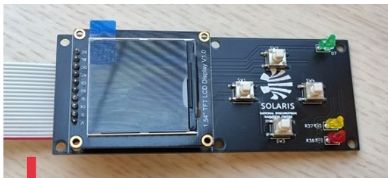
Zdjęcie 1. Układy elektroniczne do sterowania i stabilizacji fazy sygnałów RF w akceleratorze liniowym.
