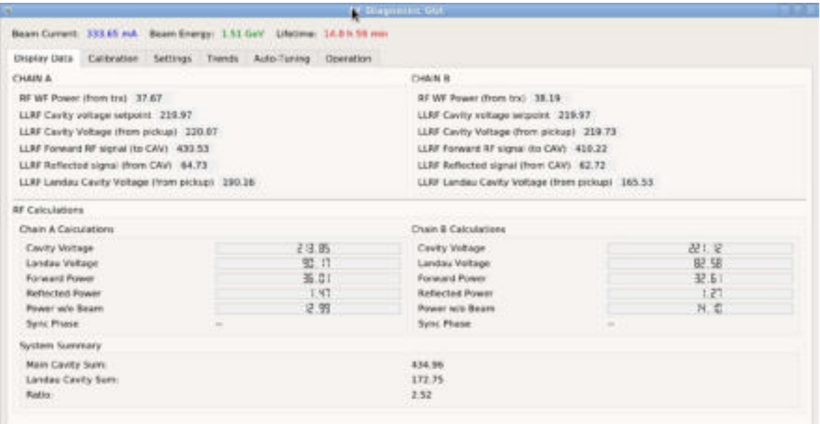
Rysunek 3. Aplikacja służąca do diagnostyki oraz strojenia wnęk rezonansowych.
